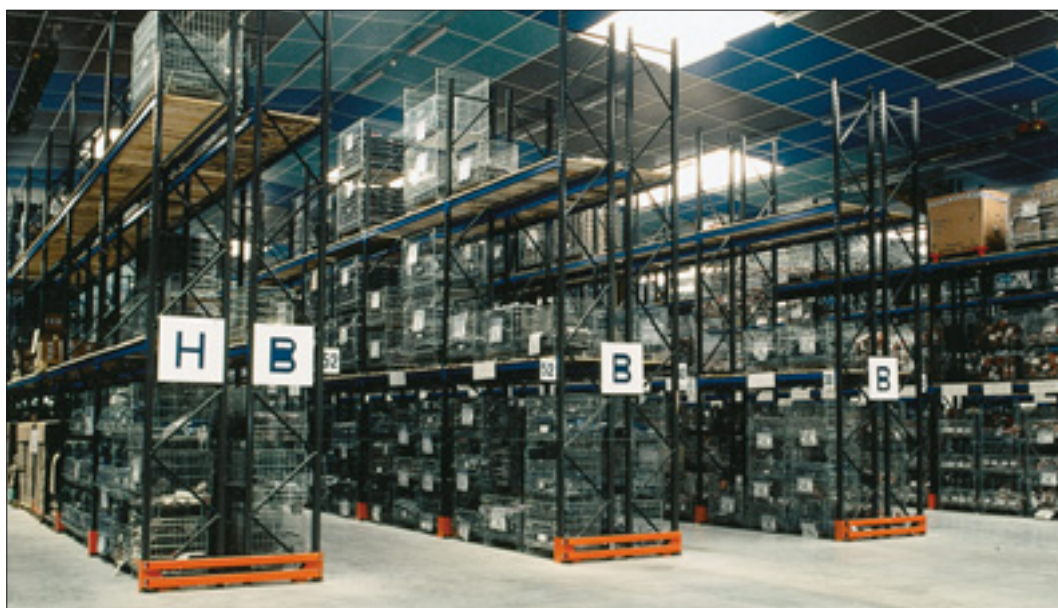
Photo 4.2 Exemple de racks aménagés sur le plan de la sécurité : plancher de positionnement et butées de pied d'échelle.
