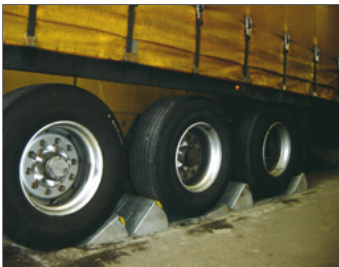
Photo 3.6 Dispositif de calage dynamique.
