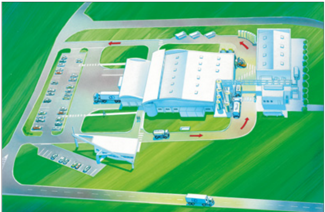
Figure 1.3 Exemple de plan de circulation d'une usine agroalimentaire.
